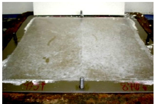
Molde con hormigón agarrado
